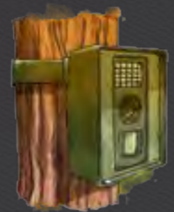
Las cámaras de fototrampeo se dejan instaladas en el área de observación elegida y se accionan por sensores de movimiento o temperatura al paso de los animales.
